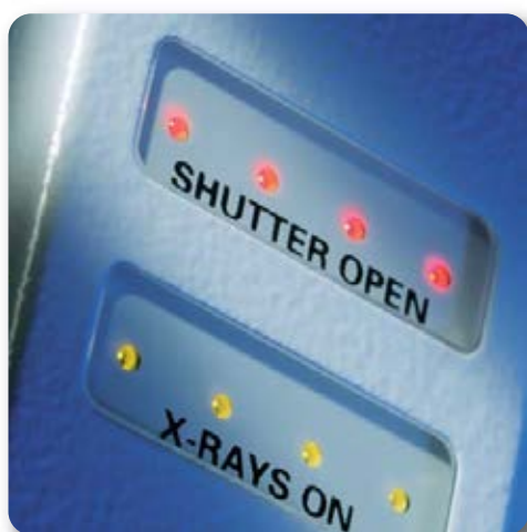
Светодиодное отображение состояния трубки
