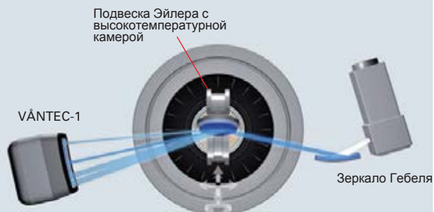
Конфигурация для измерения в нестандартных условиях с температурной камерой купольного типа DHS1100 и детектором VANTEC-1
