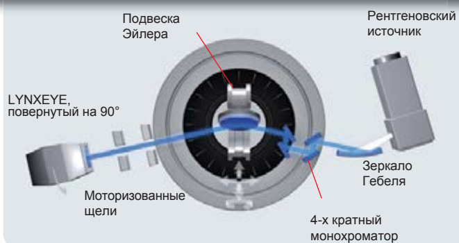
HRXRD конфигурация с 4-х кратным монохроматором
