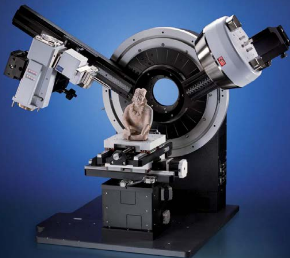
Конфигурация для микродифракции, содержащая детектор VANTEC-500 и УМС держатель с нагрузкой до 50 кг
