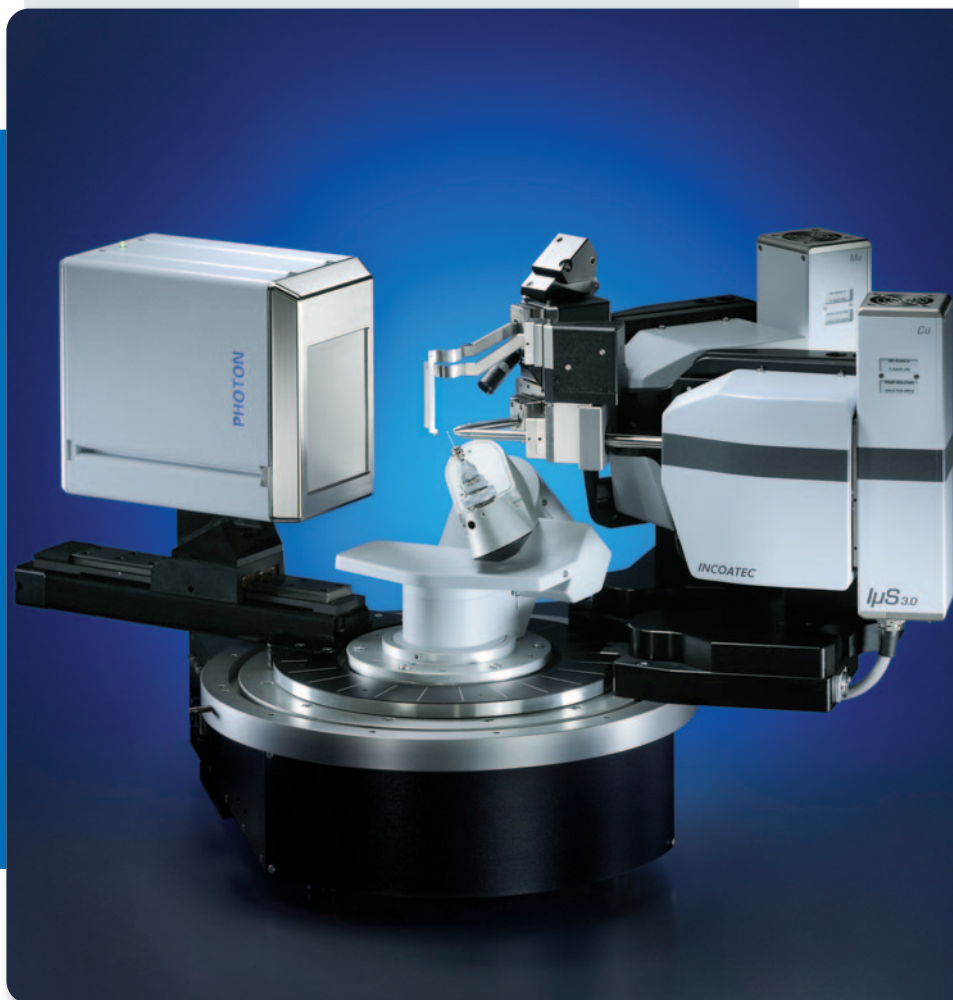
Конфигурация D8 VENTURE с двумя источниками и Mo IμS 3.0, Cu IμS 3.0, KAPPA и PHOTON III
