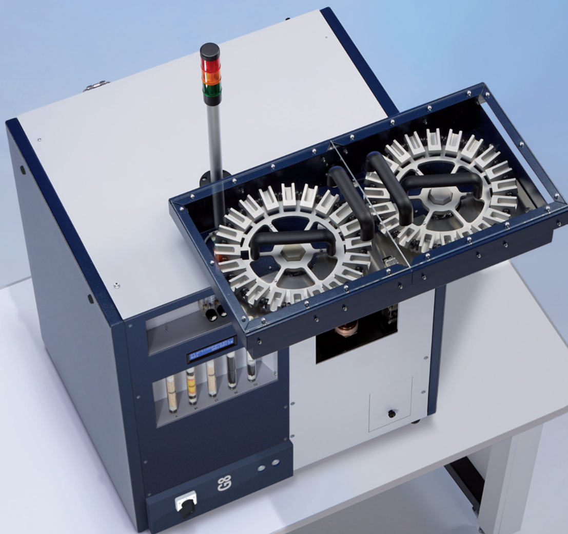
G8 GALILEO с автозагрузчиком образцов на 40 позиций для ONH анализа @ высокая производительность
