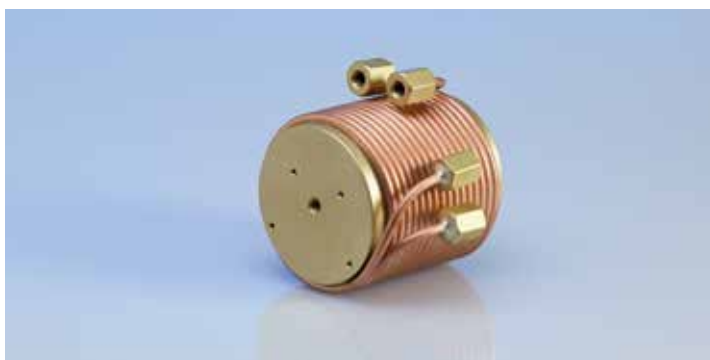
DualChannel TCD со встроенным теплообменником для одинаковой температуры аналитического газа и газа сравнения.
