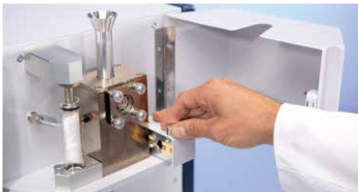
FusionControl для бесконтактного определения температуры образца в режиме реального времени имеется только у Bruker.
