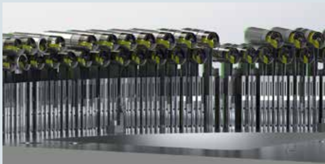
Уникальная система детектирования, состоящая из фотоэлектронных умножителей нового поколения
