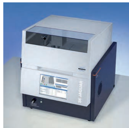
S6 JAGUAR EasyLoad с 24-позиционным пробозагрузчиком
