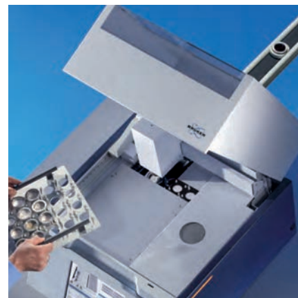
Магазин Easyload ONLINE для автоматизации с двумя дополнительными установочными позициями
