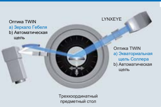
Конфигурация для работы в режиме TWIN/TWIN-геометрии под скользящим углом
