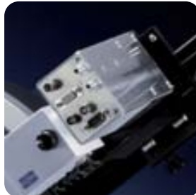
Энергодисперсионный детектор SOL-XE
