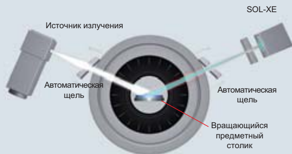
Геометрия Брэгга-Брентано с энергодисперсионным детектором SOL-XE
