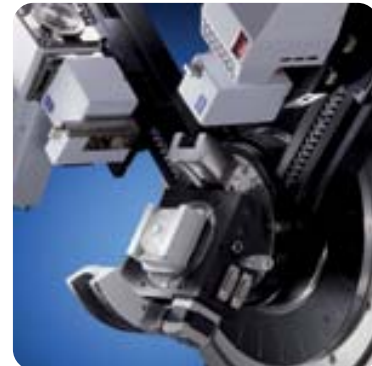
Конфигурация для анализа текстуры с TWIST-TUBE
