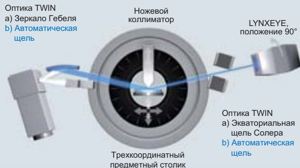
Конфигурация TWIN/TWIN с детектором LYNXEYE в положении 90^\circ , работа в режиме отражения
