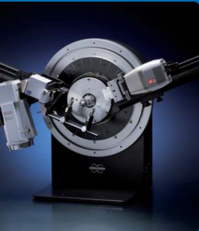
Капиллярная геометрия с монохроматором Йохансена для получения чистого K\alpha_1 -излучения, детектором VANTEC-1 и радиальной щелью Соллера для уменьшения диффузного рассеяния
