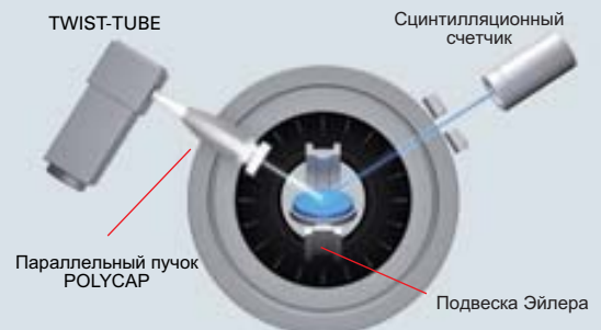
Конфигурация для анализа текстуры рентгеновской трубкой TWIST-TUBE и компактной подвеской Эйлера
